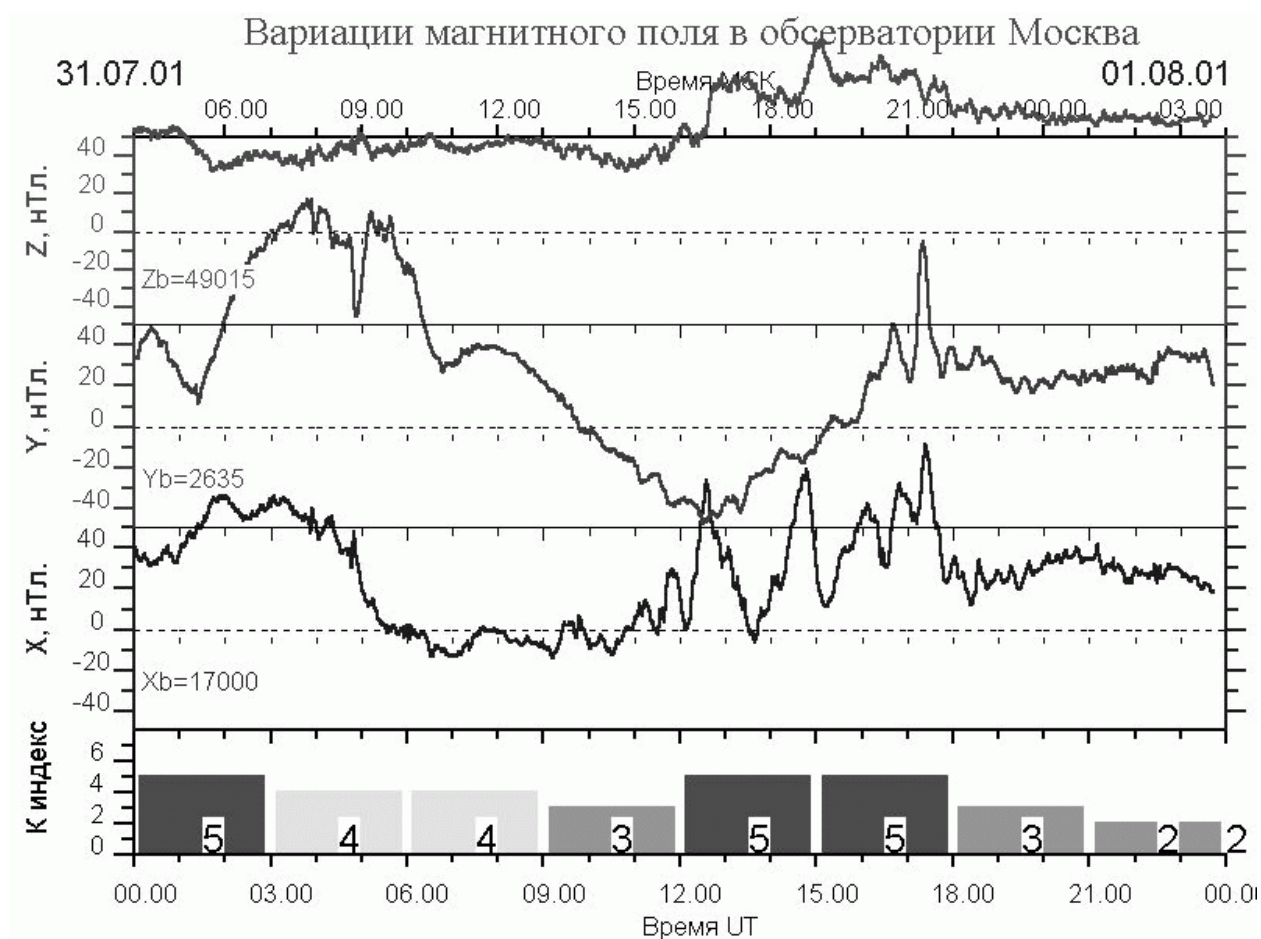
Рис. 2. Пример записи вариаций магнитного поля в обсерватории Москва в формате сайта в Интернет http://forecast.izmiran.ru . Нижний график представляет определения K -индекса.
